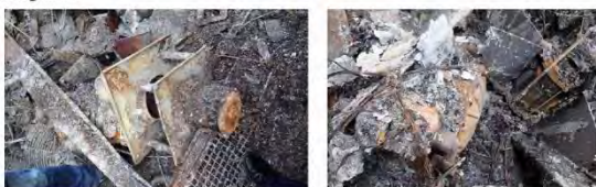
Foto nr.8 – elemente ale instalației de climatizare căzute pe șasiul vagonului
