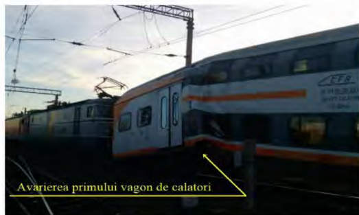
Primul vagon din cuplul TE 006 al trenului de călători nr.5008 a fost deformat și suspendat de a doua osie de la primul boghiu.
