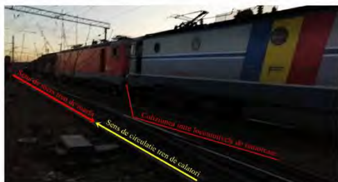
Primul vagon din cuplul TE 006 al trenului de călători nr.5008 a fost deformat și suspendat de a doua osie de la primul boghiu.
